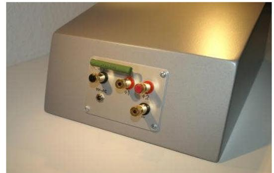
Der Standfuß ist nun fertig gestellt und wird im nächsten Schritt an das elektrostatische Panel montiert.
