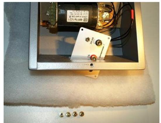
2.5. Nachdem Sie das Terminal durchgeschoben haben, sollten Sie ein weiches Tuch zwischen Rückseite und Terminal stopfen um die Oberfläche der Rückseite nicht zu zerkratzen.
