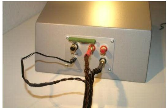
**Wichtig:** Die häufigste Ursache für Probleme bei der Erst-Inbetriebnahme ist die fehlende Stromversorgung durch eine mangelhafte Verbindung des Steckers mit der Buchse 9V-AC. Prüfen sie, ob der Stecker wirklich bis zum Anschlag in der Buchse steckt.
