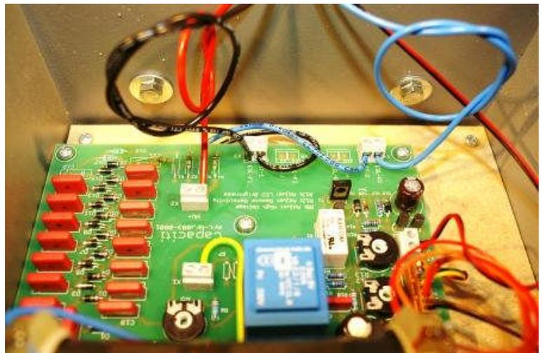
**Hinweis:** Die Überlänge der Kabel verkürzen Sie am besten durch Schlaufen der Kabel wie im Bild ersichtlich.
