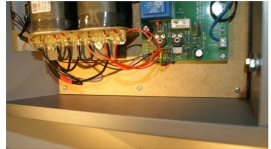
2.8. Prüfen Sie vor der Befestigung des Terminals unbedingt, ob alle Anschlüsse kurzschlussfrei sind. Beim Hindurchschieben könnten sich Kontakte verbiegen. Besonders gefährdet sind dabei die Anschlüsse der Netzteilbuchse.
