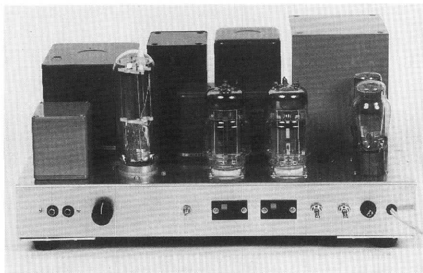
入力端子の一方は遊びで、出力端子は 8Ω 負荷が 2 系統
