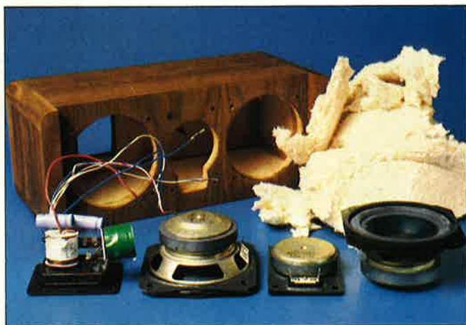
Simple Bauweise: Koss-Box mit Blechkorb-lautsprechern, einfacher Frequenzweiche und Pappe als Dämmmaterial
