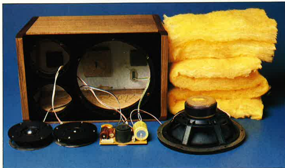
Vorzügliche Arbeit: Canton-Box mit stabilen Gußkorb- Lautsprechern, solider Weiche und genau abgestimmtem Dämmmaterial
