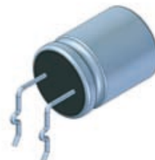
hochgesetzte Montage preparation for raised assembly
