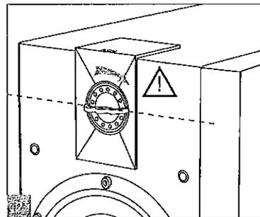
Turn the key clockwise until you meet resistance, but do not force. Tourner la clef dans le sens des aiguilles d'une montre jusqu'à la butée de sécurité, sans forcer.
