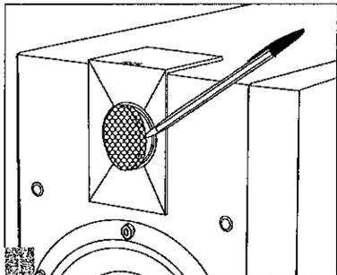
Remove the grill gently from each side using a pointed tool or object (pen...) Soulever la grille progressivement de chaque côté à l'aide d'un objet pointu (stylo...)
