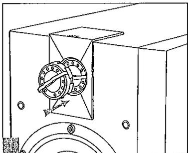
Reposition the tweeter in its compartment as indicated. Repositionner le tweeter dans son compartiment comme indiqué.
