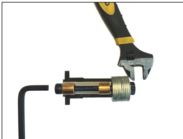
Position de l'outil pour l'extraction
