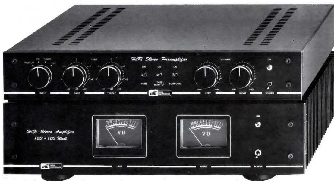
Fig.1 In questa foto potete vedere come si presenta un completo impianto Hi-Fi composto dal preamplificatore tutto a Fet, presentato sulla rivista N.169/170, e dall'amplificatore IGBT. Le due alette di raffreddamento per gli IGBT risultano fissate ai due lati del mobile metallico.
