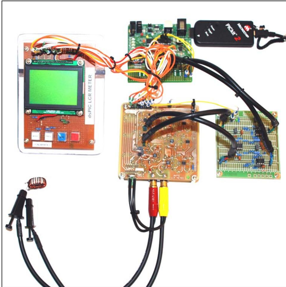
**Fig 2 : Complete dsPIC LCR Meter Prototype System.**
