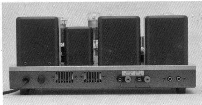
ACケーブルには直出し、出力管バイアス抵抗用の放熱孔と入出力端子がリアパネルに備わる
