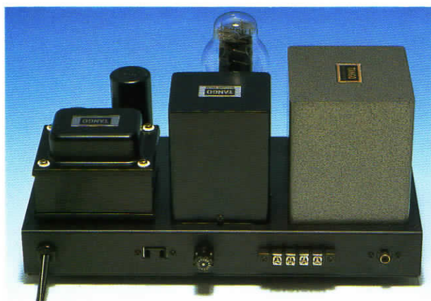
第3作の配線模様。シャシー上面の部品配置からは各パーツが無駄な隙間なくびったりと収まっているが、シャシー裏側はゆったりとしており、見るからに作りやすい
