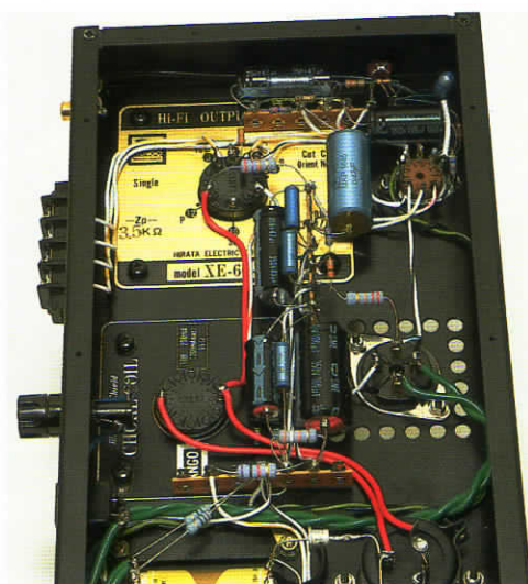
第3作の配線模様。シャシー上面の部品配置からは各パーツが無駄な隙間なくびったりと収まっているが、シャシー裏側はゆったりとしており、見るからに作りやすい
