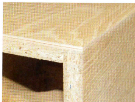
Die Furnierplatte harmonisiert farblich mit der Eiche recht gut. Ihre umlaufende Schnittkante bleibt sichtbar, was aber nur bei näherem Hinsehen auffällt.
