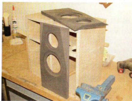
Die Fronten aus schwarz durchgefärbtem MDF mit allen Fräsungen und den seitlichen Abschrägungen lieferte Dennis Rohr von SpeakerCase.
