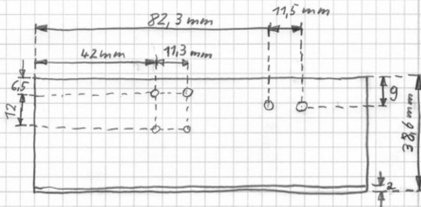
All drill holes  $\varnothing 3,5\text{mm}$
