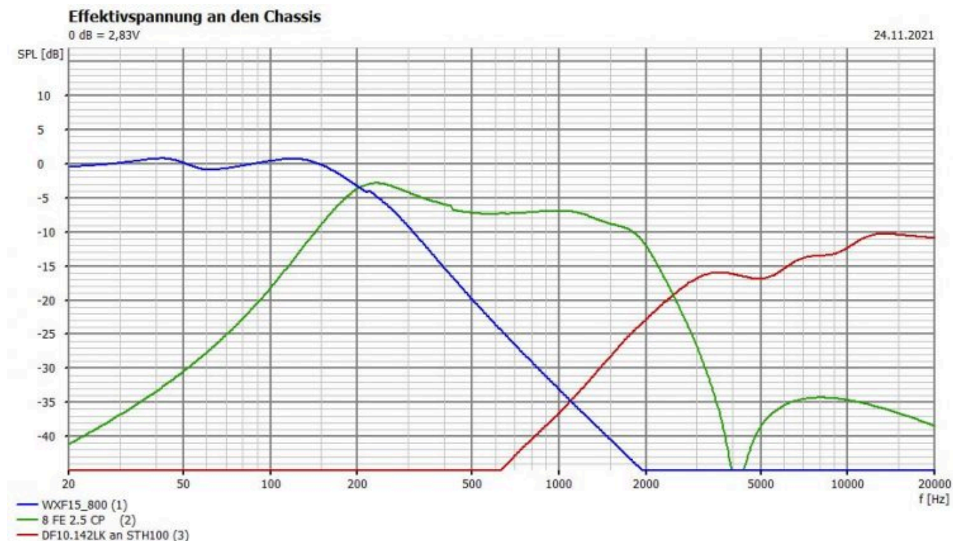
Kaventsmann Effektivspannung an den Chassis (elektrische Trennfrequenzen)
