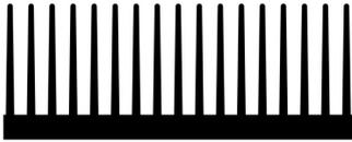
Profilkühlkörper und Flüssigkeitskühlkörper > Standardstrangkühlkörper
