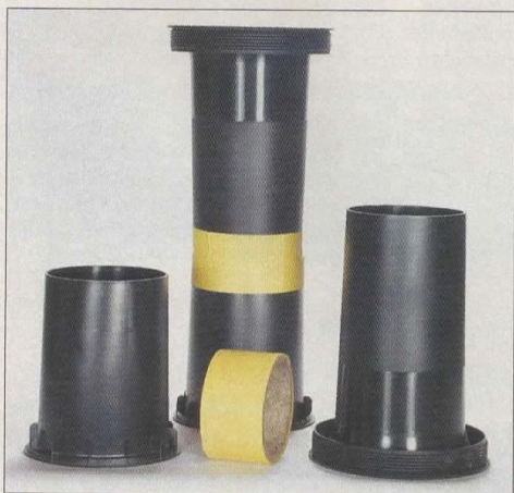
Der Bassreflexkanal besteht aus den Rohren HP 100 und TR 100 von Intertechnik, die so kombiniert werden, dass sich ein Reflexkanal mit strömungsgünstiger Aufweitung an beiden Enden ergibt. Das innere Rohr besitzt einen kleineren Durchmesser und passt daher durch den Gehäuseausschnitt.
