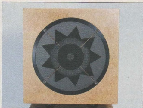
Das Mittelhochtongehäuse mit dem Manger-Schallwandler steht auf Spikes, damit Schwingungen des Bassgehäuses möglichst wenig übertragen werden. Damit die Spikes nicht verrutschen, sind kleine Spanplattenschrauben mit Torx-Senkkopf bündig in die Oberseite des Bassgehäuses eingedreht. Sie dienen als Widerlager für die Spitzen der Spikes.
