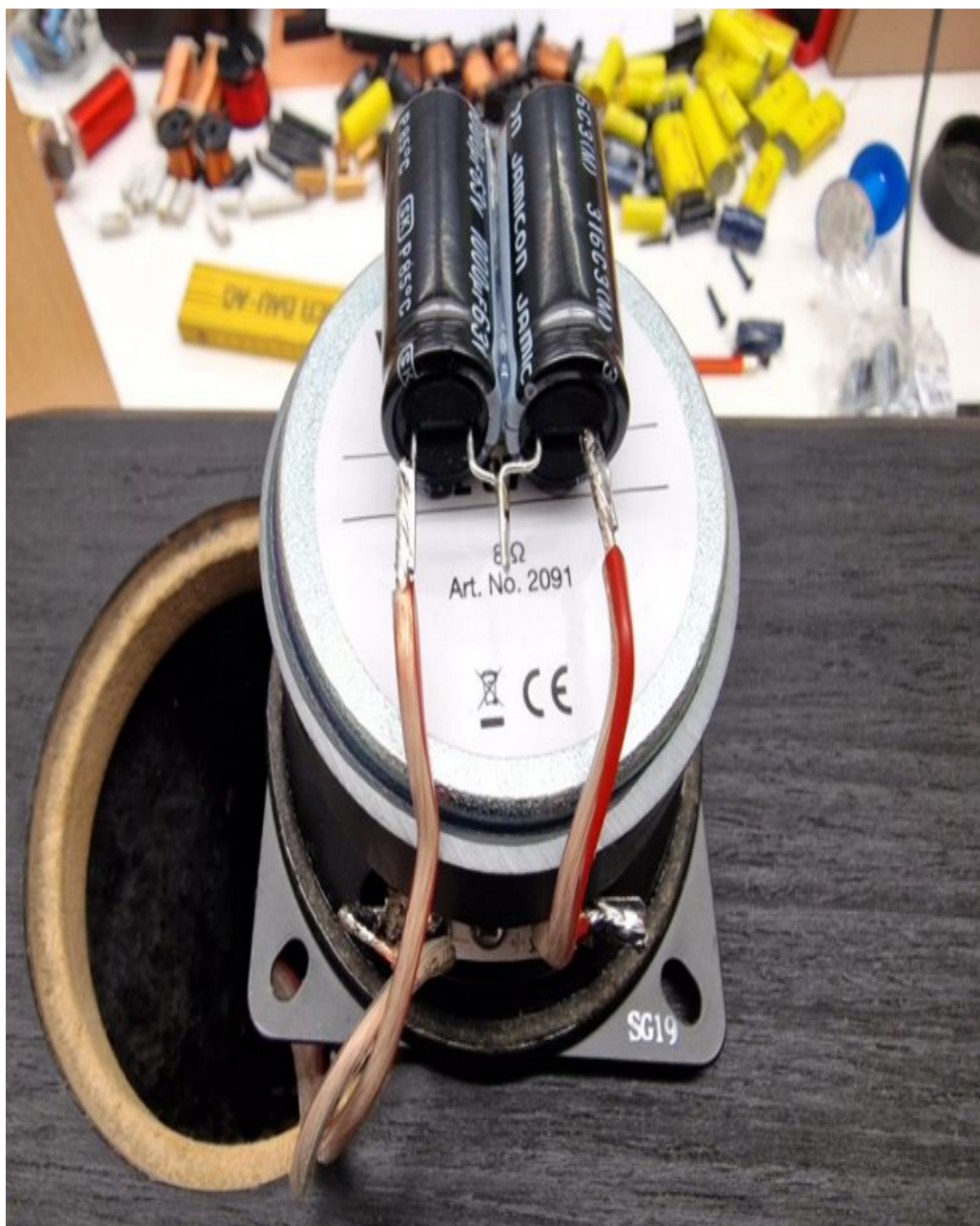
Quasi bipolarer 500 \mu F Elko in Plus-Zuleitung des SL87FE
