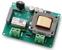
Das TSRO1 ist ein elektronisches Relais zum Schalten von Transformatoren. Es schaltet einen oder mehrere Einphasentransformatoren im Leerlauf oder unter Last ohne Einschaltstromstoß (Inrush) ein. Durch ein Sanft-Einschalt-Verfahren wird der Einschaltstromstoß vermieden und nicht nur begrenzt.
