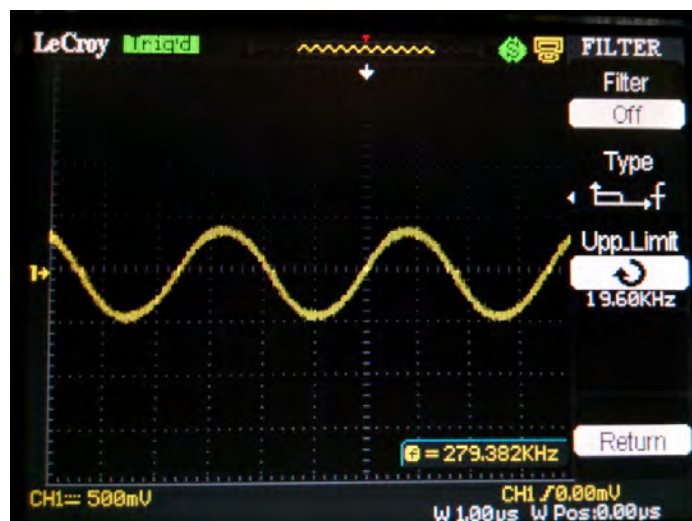
Gambar-1 Vout menunjukkan residu PWM, diukur di output terminal dalam keadaan speaker terpasang
