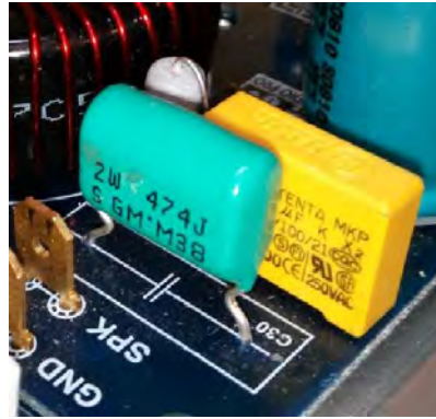
Polyester based capacitor untuk LLC resonant (biru)
