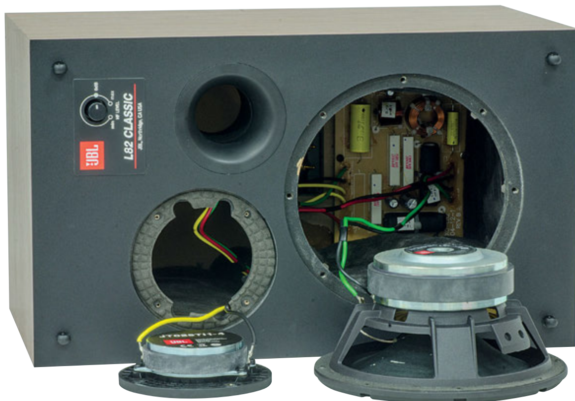
Il diffusore con gli altoparlanti smontati. Notiamo il buon complesso magnetico del tweeter, il buon condotto di accordo e la solidità costruttiva del midwoofer.
