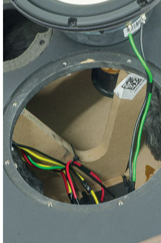
All'interno del box si può vedere il notevole rinforzo a V che irrigidisce le pareti senza creare particolari colorazioni interne.
