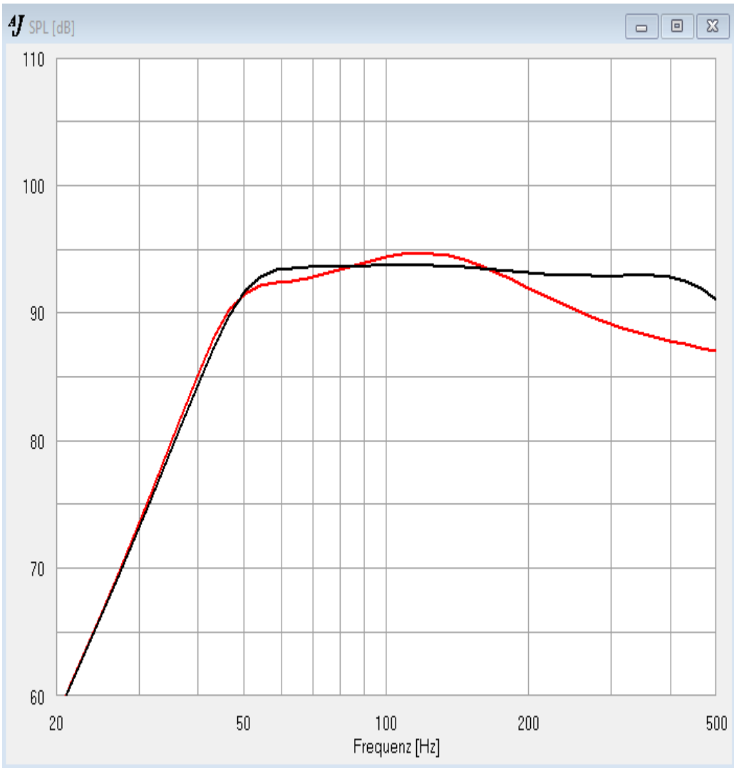
Simulation der beschalteten TT und TMT in AJHorn (ohne Schallwandeinfluss)
