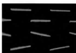
【写真10】方形波応答波形 (L-ch, f=100\text{Hz} , R_L=8\Omega , 出力 1V_{\text{rms}} , 上: 入力, 下: 出力)
