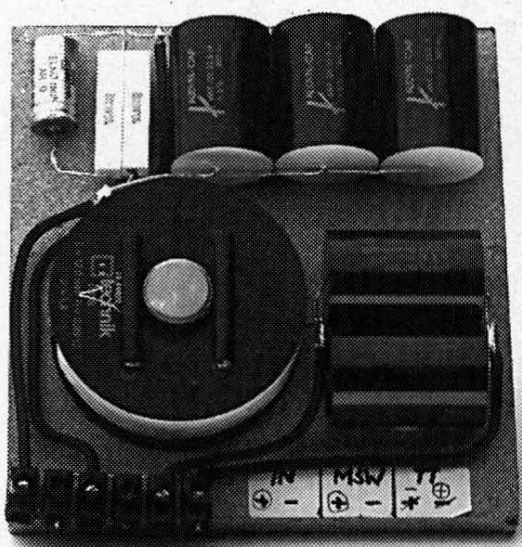
Die Frequenzweiche der Manger-Zerobox 105: Optisch dominieren die großen Folienkondensatoren. Durch Herausziehen des Corobarkerns aus der 12-Millihenry-Spule um 6 Millimeter ergibt sich die von Manger geforderte Induktivität von 11,4 Millihenry.
