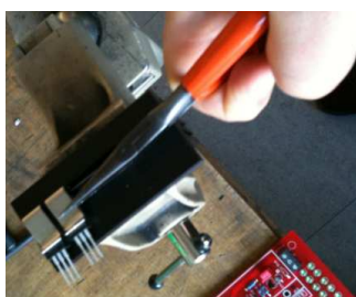
Montage der Leistungstransistoren
