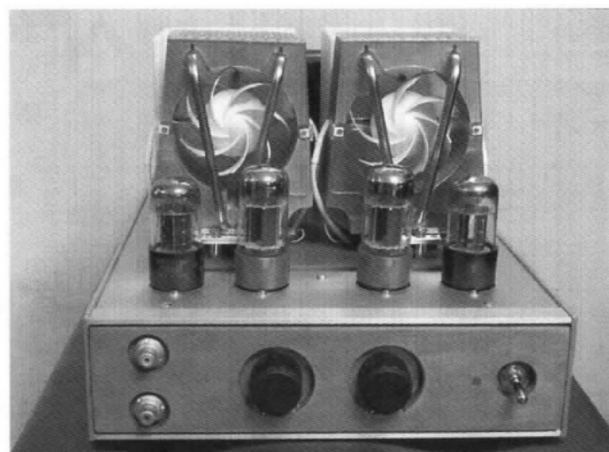
本機の外観.大型の放熱器でSITを冷却
