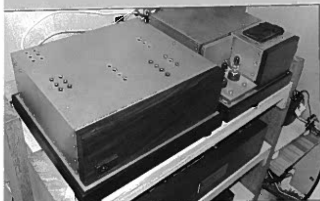
Les circuits d'alimentation du préamplificateur à tubes. Ils ont été montés dans des boîtiers blindés réalisés en plaques de cuivre de 12 mm d'épaisseur.
