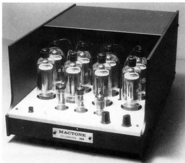
〔写真11〕 1987年に発売された50W/8ΩのOTL & OCLモノラルパワーアンプM-8（発売時価格550,000円）NFB量可変機能付き
