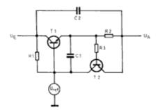
Bild 4 zeigt die Netzteilschaltung. T1 ist der Längstransistor, dessen Basis an der stabilen Spannung UREF liegt. UA ist somit gut gesiebt und stabil. Bei Überlast fällt an R2 so viel Spannung ab, daß T2 über den Strombegrenzungswiderstand R3 aufgesteuert wird und den Basisstrom von T1 begrenzt. Die Anordnung ist auf einen festen Maximalstrom eingestellt und dauerkurzschlußfest.
