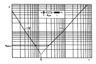
In Bild 9 ist der idealisierte Impedanzverlauf eines typischen Elkos und dessen Ersatzschaltung dargestellt. Die einzelnen Teile der Ersatzschaltung sind folgendermaßen definiert:
